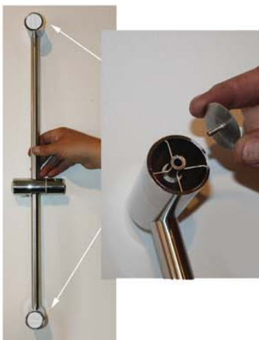
Placera limbelagda brickorna i skruvhålen.
